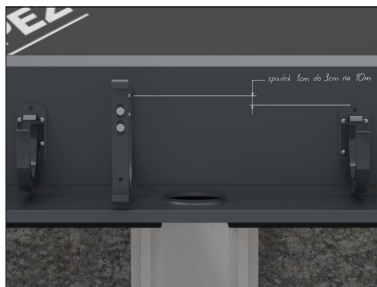
Najniższy punkt montażu haka z lejem spustowym.
